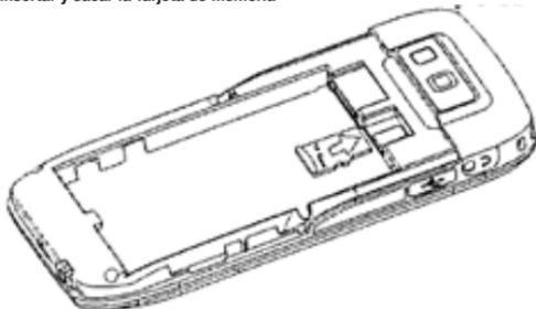
Inserte la tarjeta de memoria en el soporte y apriete la cubierta de presión de la tarjeta para que quede fija en la ranura.
